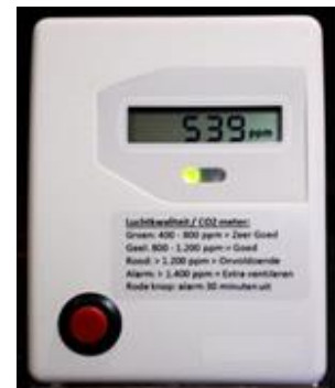
Afbeelding: voorbeeld van een CO 2 -meter met stoplichtfunctie (rood, oranje, groen)
